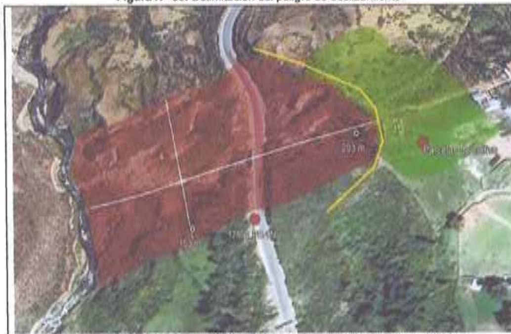
Figura N° 50. Delimitación del peligro de deslizamiento
