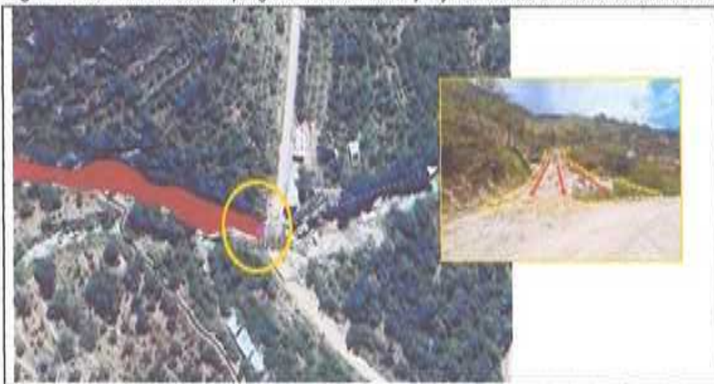
Figura N° 72. Delimitación de peligro de deslizamiento y flujo de detritos en la vía vecinal LM-571
