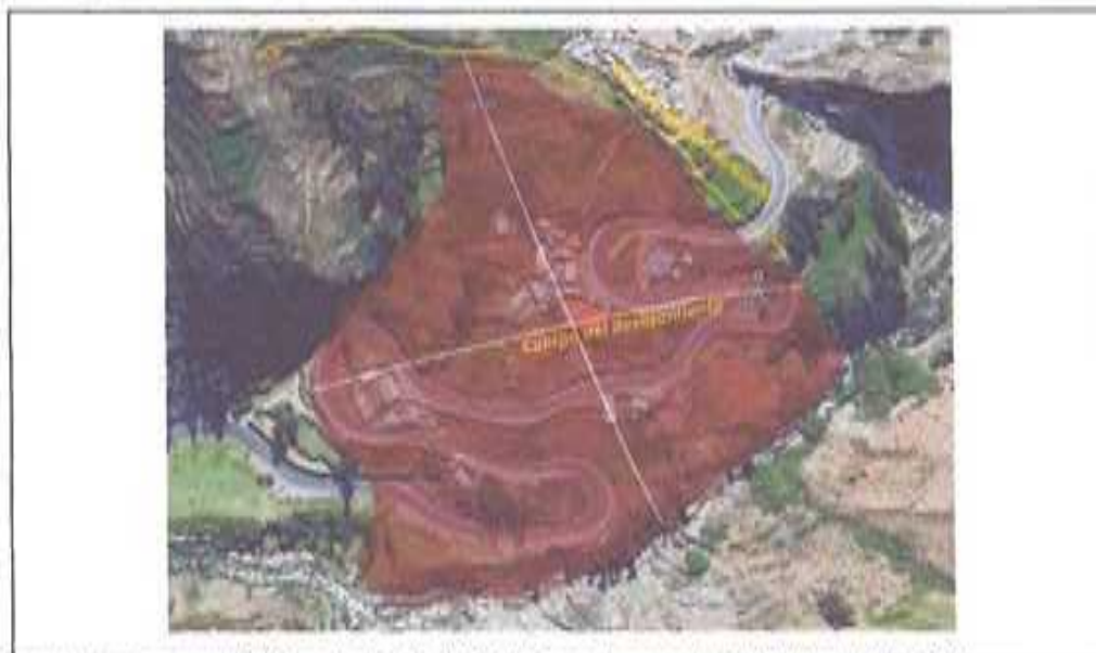
Figura N° 36. Imagen satelital del área de deslizamiento con corona de inicio ruptura.
