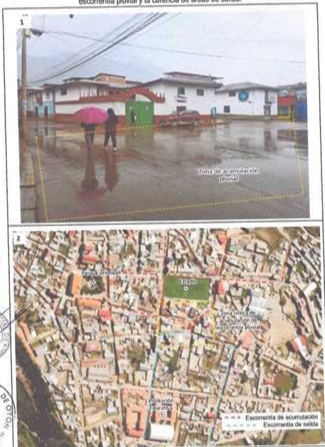
Figura N° 55. Zona crítica a inundación pluvial; (1) zona de acumulación pluvial, (2) esquema de escorrentía pluvial y la carencia de áreas de salida.
